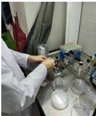
▲將培養基倒入已加入樣品稀釋液之培養皿並以 8 字搖晃混合均勻
